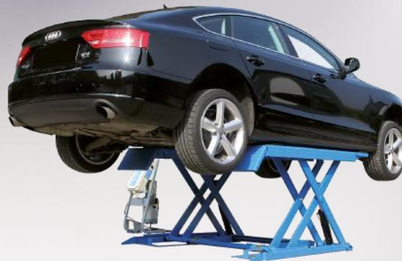
Elévateur idéal pour les interventions sur les pneus, les freins, les amortisseurs et les carrosseries. Le fonctionnement électrohydraulique avec des durées de cycle très réduites, associé à une capacité remarquable et un levage élevé caractérisent cet élévateur de la dernière génération en garantissant à l'utilisateur le maximum de sécurité, la fonctionnalité et la commodité d'emploi. Synchronisation mécanique des mouvements des plateformes indépendante de la distribution de la charge.
